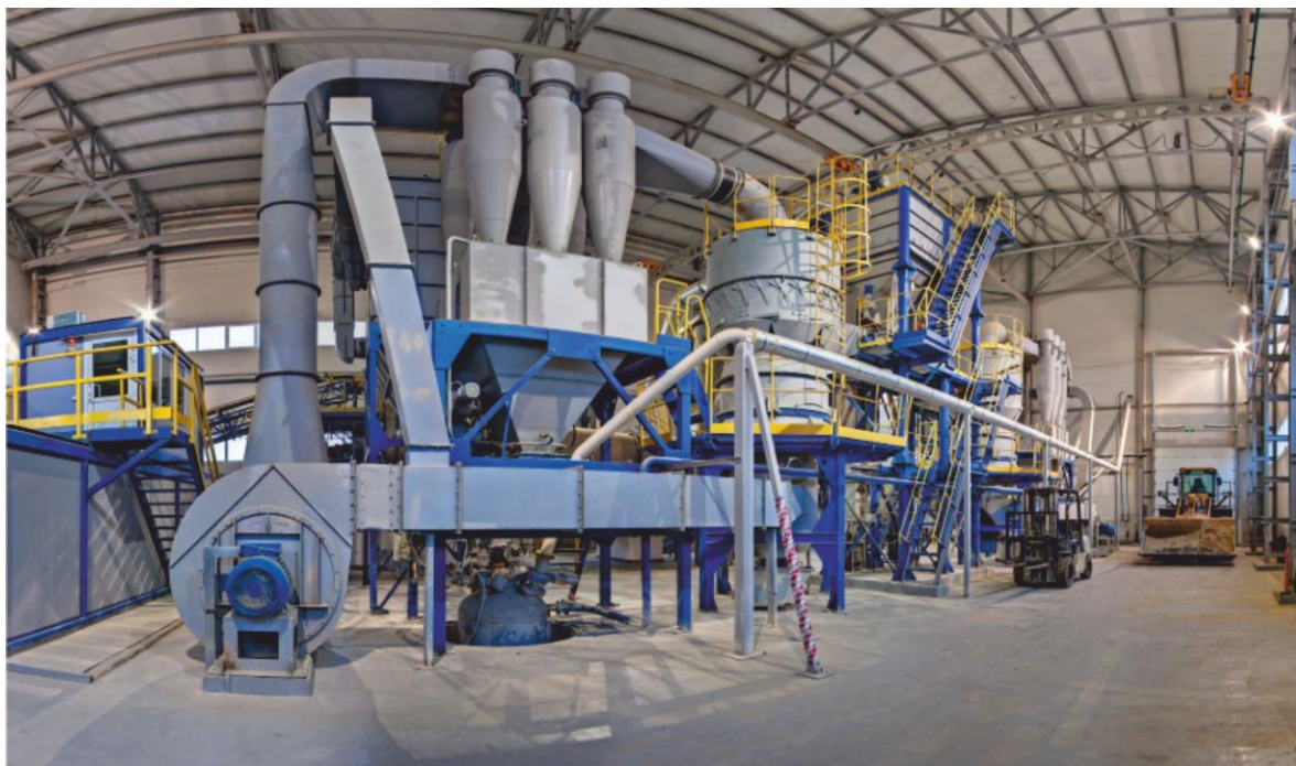
Рисунок 2. Измельчительный комплекс КИ для изготовления цемента
